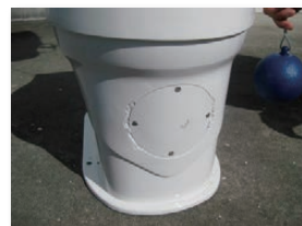
③表面に傷が付かず終了しました。 (青い部分は鉄球の塗装)
