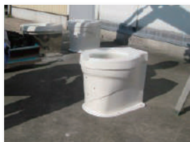
①FRP製洋風大便器の正面に鉄球が当たる位置に配置
