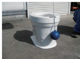
②高さ100cmから鉄球を落とします。
